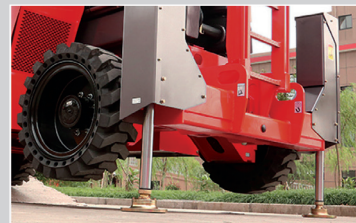
Automatische, selbstnivellierende Stabilisatoren
